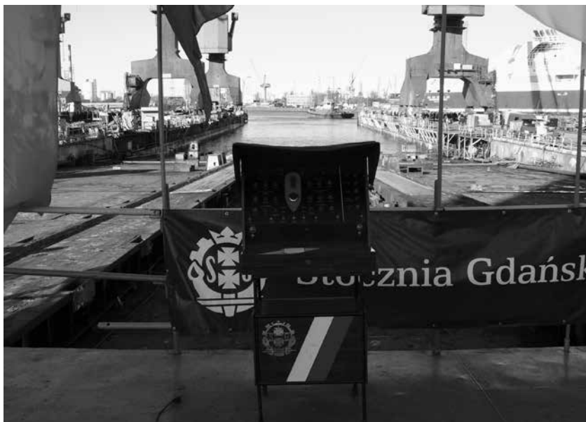
Przenośny pulpit do kierowania operacją wodowania kadłuba; fot. W. Affelt, 2013
